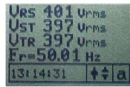
Trascorso il tempo di attivazione (300 secondi previsti dalla norma, visualizzati in decremento) viene comandata la chiusura del DDI . Nelle altre aree di monitor si ha l'indicazione dello stato dei relè di uscita e del modo di lavoro.
